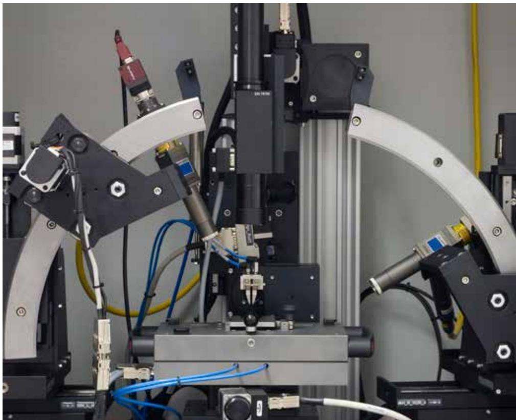
è stata trovare sul mercato un sistema di controllo in grado di spostare i laser con una tolleranza del 10%", afferma Gunter Hummelt, Direttore Tecnico di Nanosystec. "Per risparmiare spazio, e costruire un dispositivo più compatto, abbiamo optato per un sistema basato su un circuito curvilineo invece di utilizzare un sistema con gli assi XY".
